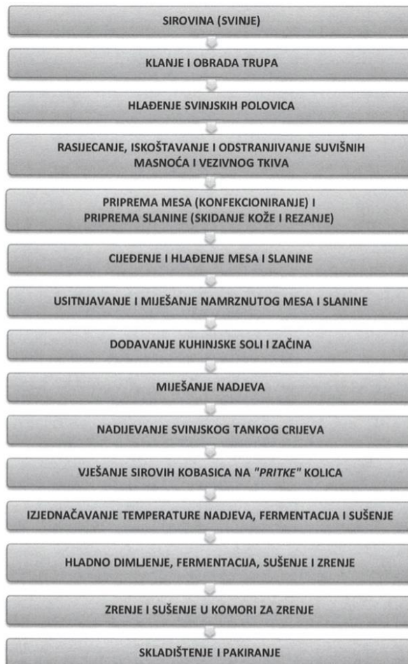
Slika 12.1.-2. Tehnološka shema tradicionalne tehnologije proizvodnje domaće slavonske kobasice.
